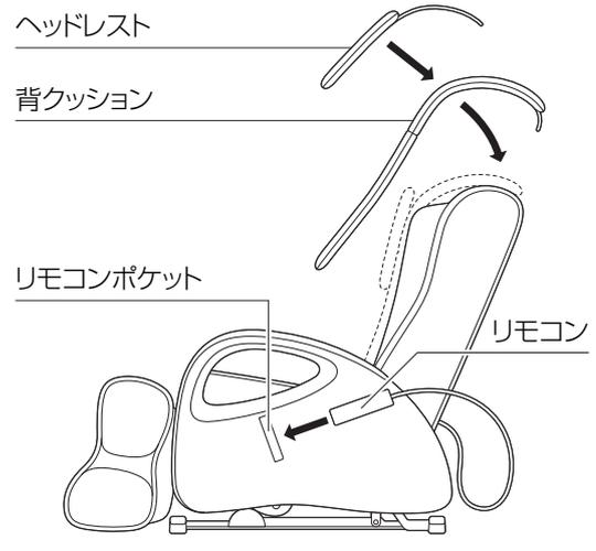
3. 背クッション・ヘッドレストを背もたれにセットし、リモコンをリモコンポケットにセットしてください。
