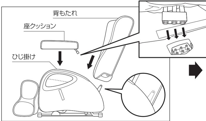
1. 座クッションをセットして座クッション台右上部にあるエアージョイント受け部に接続してください。次に、ひじ掛けの金具を背もたれの金具の中に「カチッ」音がするまで差し込んでください。
