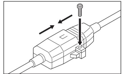
六角穴付ボルト(付属品)を六角レンチ(付属品)でねじ止めし、コネクタを固定してください。
