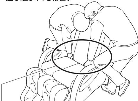
● 本体ひじ掛けを脚で押さえ、背もたれの両側・金具部分にあるボタンを押しながらゆっくりと背もたれ全体を持ち上げて取り出す。ボタンを押さないと背もたれを持ち上げると、取り付け部が破損するおそれがあります。
