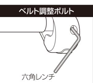
※適度なベルトの張り具合は、ベルト全体が板から少し浮き上がった状態で、ベルトの中程の端をつまみ上げ約3cm程度持ち上がる状態です。
